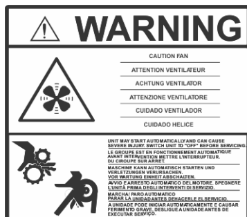
Рис. 2. Предупреждение о состоянии вентилятора
